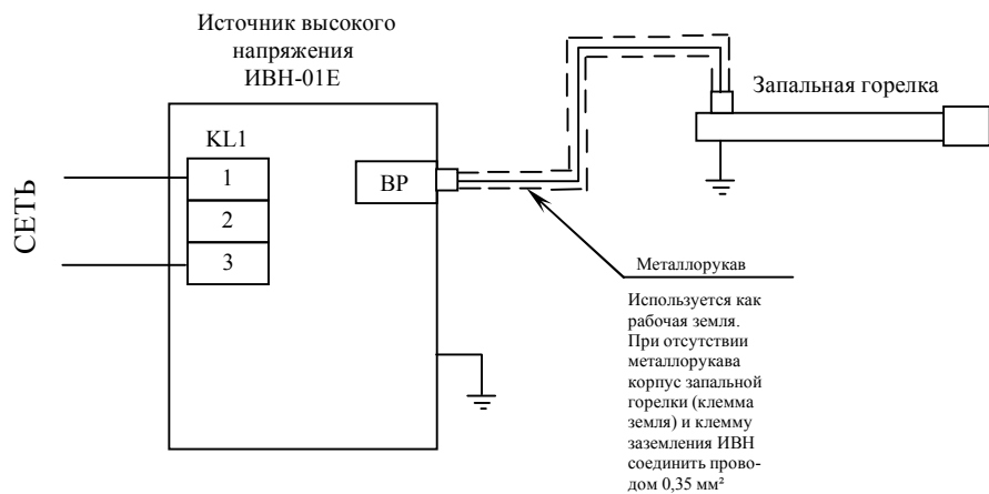
Рис. 3. Схема электрических соединений ИВН-01Е с электродом запального устройства (запальной горелки).
