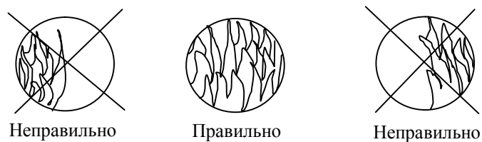
Рис. 10. Расположение датчика относительно пламени и вид на пламя через визирную трубу.
